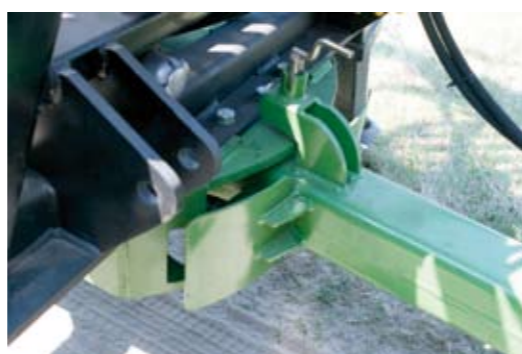
Hydraulicznie łamany dyszel zwiększa manewrowość przyczepty w lesie
