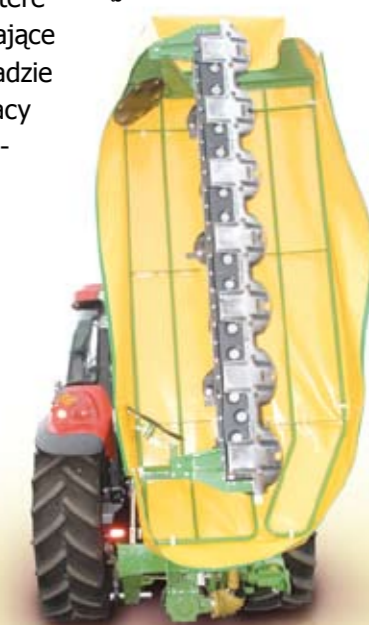
Kosiarka PDT 290 w pozycji transportowej pionowej z tyłu ciągnika
