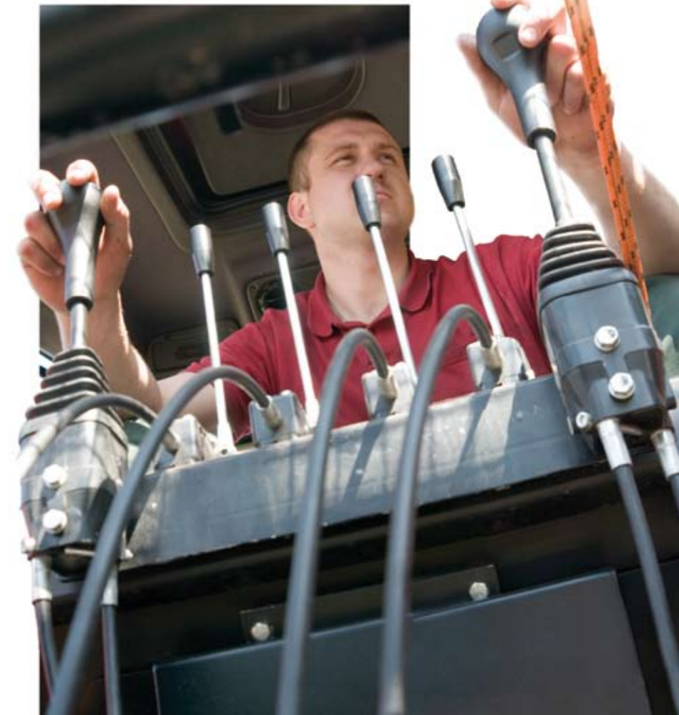
Sterowanie przyczepą odbywa się z kabiny ciągnika przy pomocy zestawu joysticków mocowanych na tylnej belce kabiny
