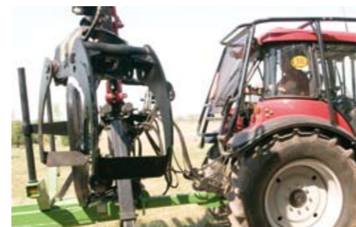
Wykonana z rur rama ochronna oraz siatkowa osłona szyby chronią kabinę ciągnika przed gałęziami
