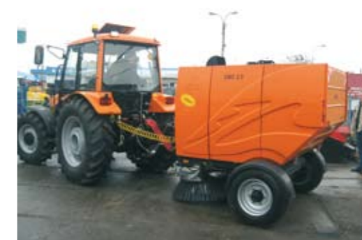
Po pokazie zmiataania zaprezentowano opróżnianie zbiornika z zanieczyszczeniami
