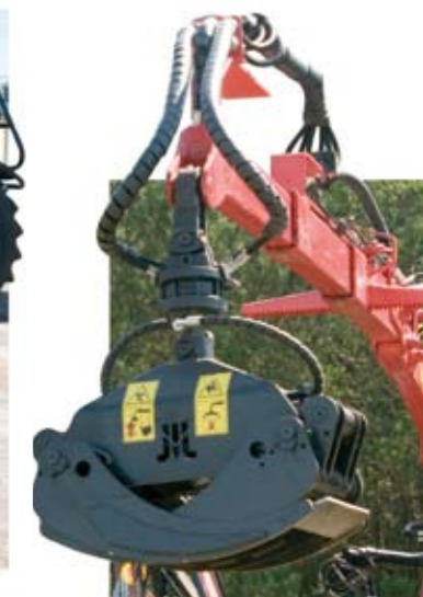
Ładowacz przyczepy wyposażony jest w rotator umożliwiający obrót chwytaka dookoła jego osi
