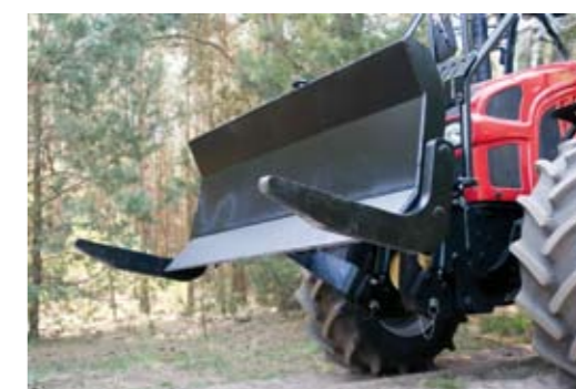
Lemiesz czołowy leśny LCL16 może być wyposażony w hydrauliczny łącznik centralny pozwalający na sterowanie kątem pochylecia lemisza oraz ramion
