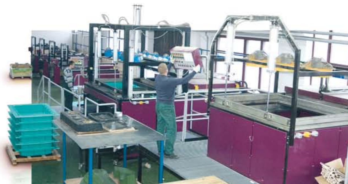
Pracownik wykonuje elementy z tworzyw sztucznych metodą termoformowania próżniowego
