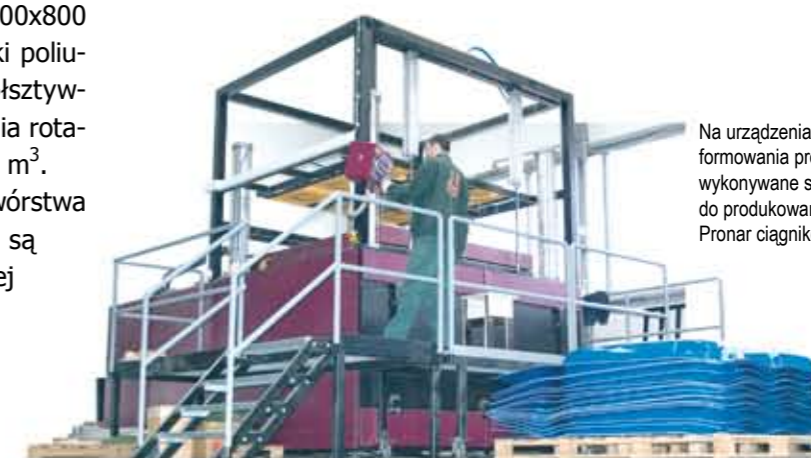
Pracownik wykonuje elementy z tworzyw sztucznych metodą termoformowania próżniowego
