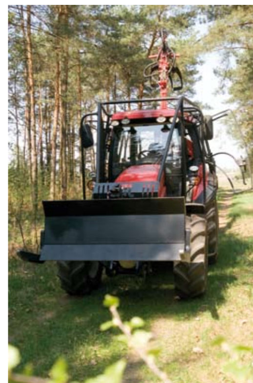
Lemiesz czołowy leśny LCL16 zamontowany na przednim TUZ-ie ciągnika PRONAR 5135
