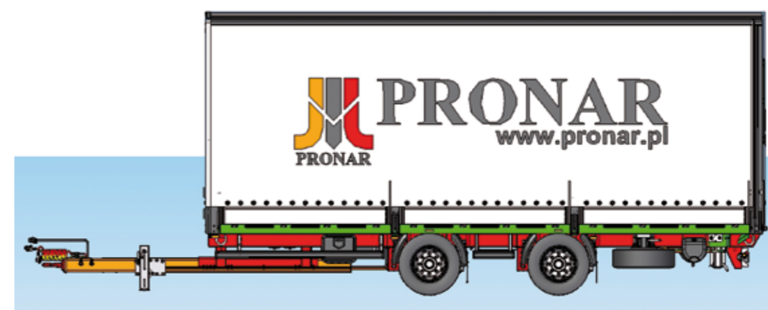
Przyczepa PC2200 (widok z boku) wraz z wyposażeniem dodatkowym - kołem zapasowym, skrzynką narzędziową i zbiornikiem na wodę
