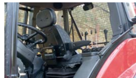
Kabina ciągnika PRONAR 5135 została wyposażona w obrotowe siedzisko, ułatwiające operatorowi sterowanie maszyną umieszczoną z tyłu ciągnika
