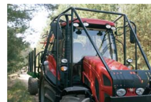
Ciągnik wyposażony jest w osłonę kabiny oraz w rurowe osłony maski
