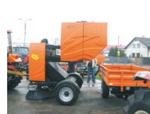
Zmiatarka z uniesionym zbiornikiem zanieczyszczeń podjeżdża do przyczepy
