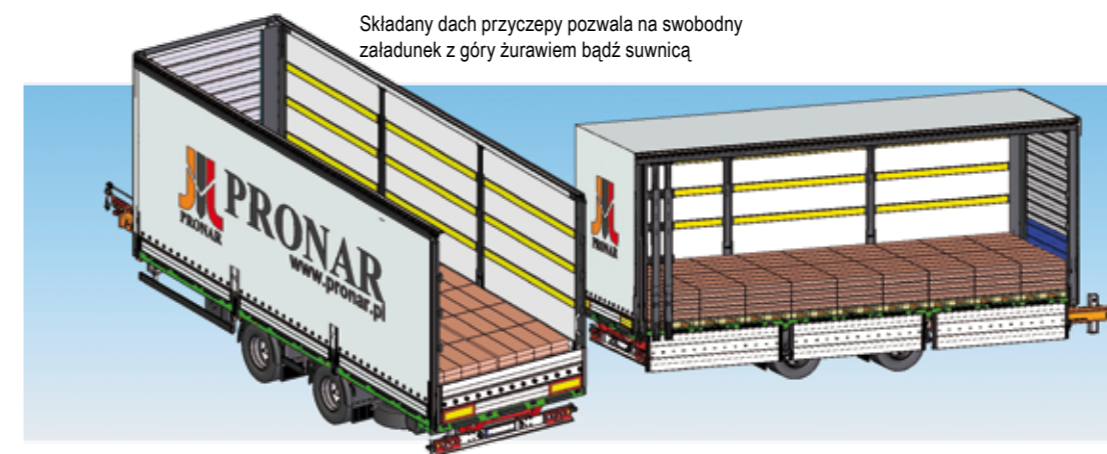
Całkowicie zsunięta kurtyna boczna wraz z słupami środkowymi pozwala na szybki boczny załadunek długich elementów
