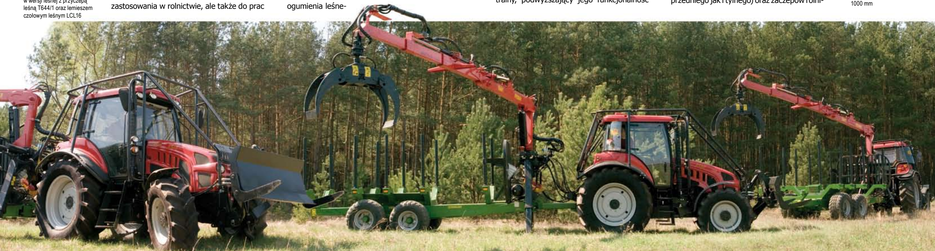
Rozwarcie łap chwytaka umożliwia pewny chwyt materiału w zakresie średnic od 60 do około 1000 mm
