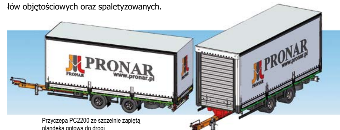
Ściana przednia przyczepy PC2200 jest wykonana z profili aluminiowych. Dyszel posiada zakres regulacji \pm 450 mm, a noga podporowa - płynną regulację wysokości
